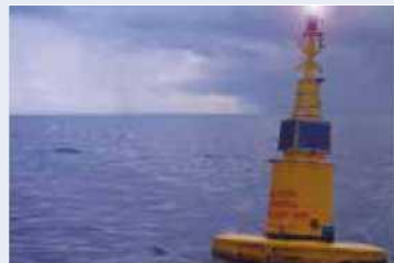
L'une des balises de suivi équipée de capteurs océanographiques, d'enregistreurs acoustiques et de dispositifs de traçage des poissons.
