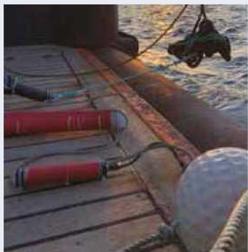
Application d'instruments de mesure acoustiques et océanographiques ancrés.
